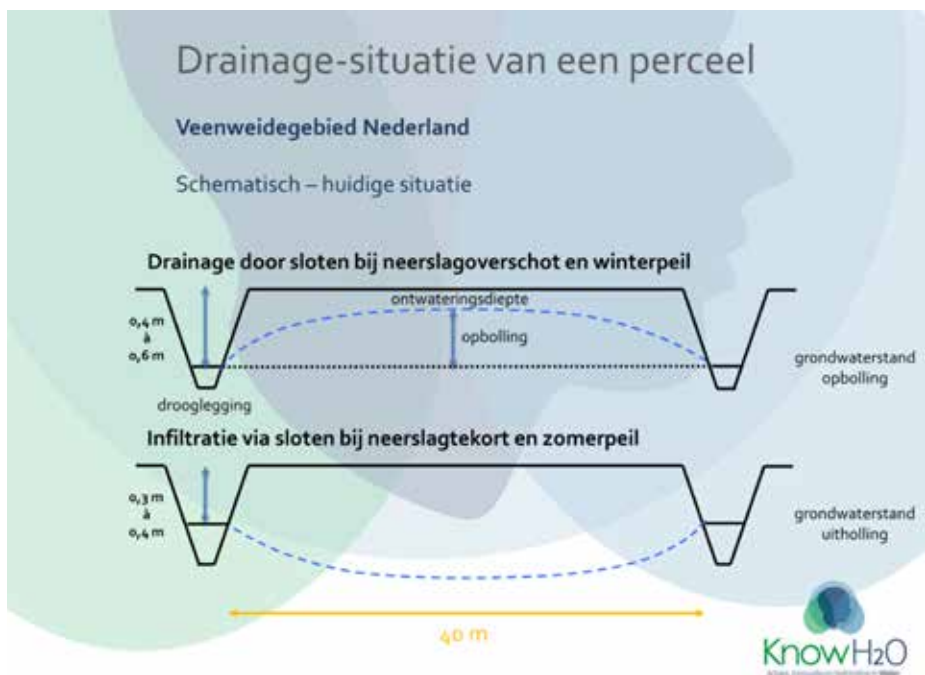
Figuur 11: Standaard-schematische situatie van een dwarsdoorsnede van een veenweideperceel van 40 m breed met bolle (afvoersituatie) en holle grondwaterstand (aanvoersituatie).
