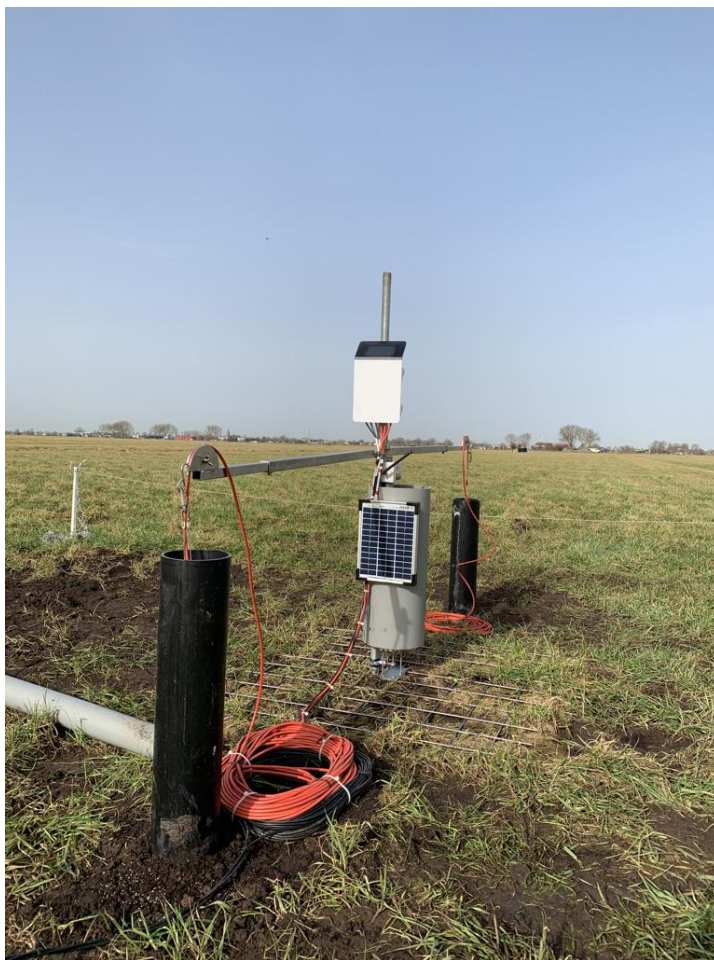
Figuur - Foto van VSM-sensor op proefperceel bij Kees Baan (VSM-West). Twee grondwater-peilbuizen ondiep en diep staan in directe omgeving ervan, mede gefundeerd door VSM-sensor-opstelling in het midden (met gefundeerde pin).
