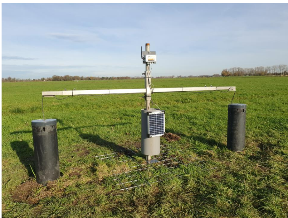
Figuur - Foto van VSM-sensor op proefperceel bij Peter Heikoop/Jan den Besten (VSM Oost). Twee grondwater-peilbuizen ondiep en diep staan in directe omgeving ervan, mede gefundeerd door VSM-sensor-opstelling in het midden (met gefundeerde pin in zandpakket).
