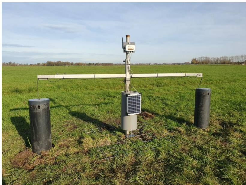
Figuur 31. Bodembeweging maaiveld continu meten met twee VSM-sensoren bij Heikoop te Nieuwland. Impressies van werkzaamheden op 22 oktober 2025 (plaatsing opstelling met pin) en installatie sensoren op 10 en 12 november 2025.
